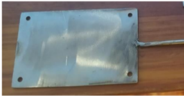
Gambar 2.4 Bentuk 1 kisi lempengan stainless
