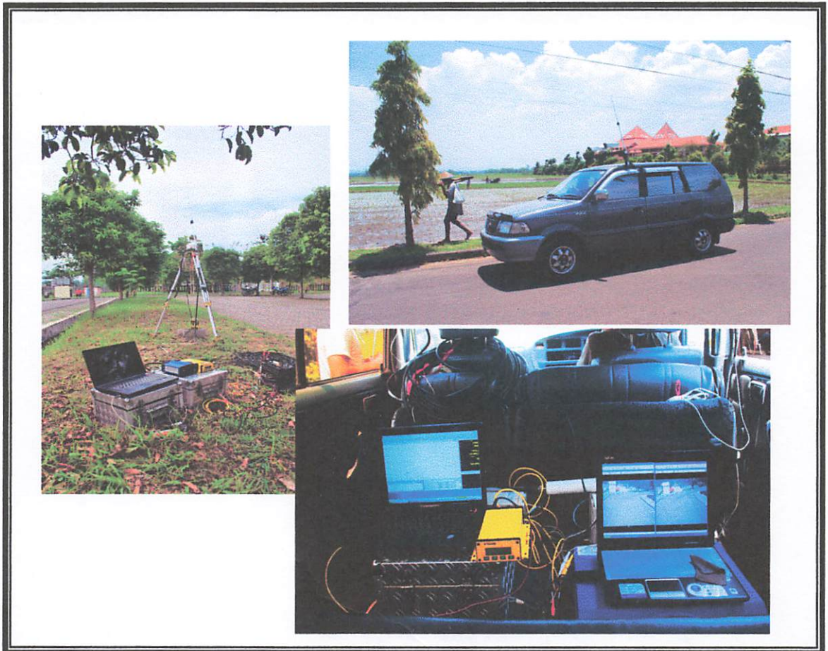
Gambar 3.12 (kiri): Stasiun DGPS (base station); (kanan-atas): Sistem Pemetaan Cepat yang Dipasang Pada Mobil; (kanan-bawah): Laptop sebagai alat monitoring dan controller dalam pengambilan data posisi dan gambar
