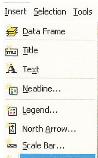
Gambar III.77. Langkah Pembuatan Skala Bar Peta
