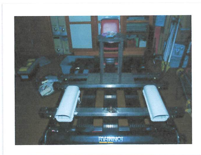
Gambar 3.8 Roof Rack untuk tempat kamera IP
