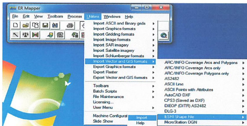
Gambar 3.5. Tampilan Menu Utilities untuk proses Import dari file shp . Ke file erv .
