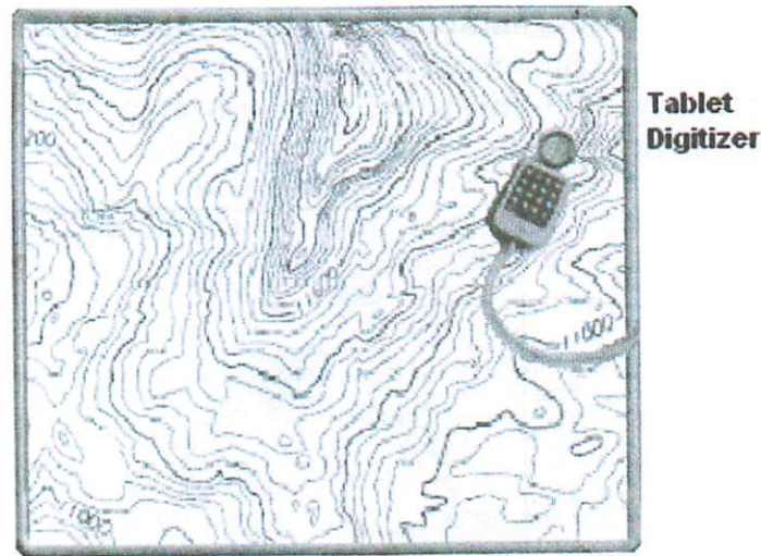
Gambar 2.17 Contoh Tampilan Perekaman DTM dari Peta Topografi (Garis-Garis Kontur) dengan Table Digitizer , Eddy Prahasta (2008)
