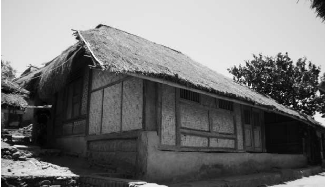
Gambar 3.14. Bale-bontar beleq , bentuk atapnya khusus bagian depannya tidak ada lengkungan sampai dengan bagian sesangkok (photo: Gatot Adi S.)
